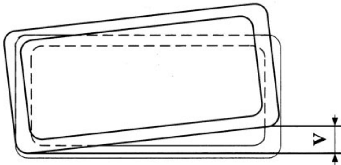
**Рис. 8 Общее измеренное скручивание (деформация кручения)**
