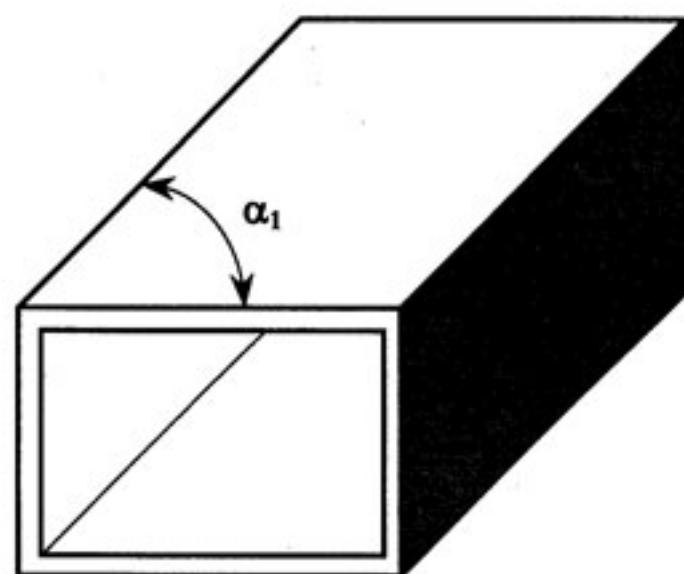
**Рис. 10 Отклонение линии реза (косина реза)**
