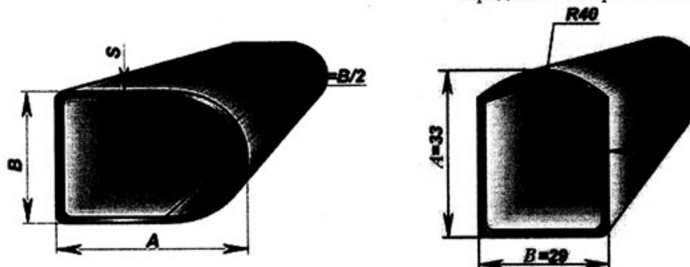
Таблица 17. Трубы из горячекатаной травленой резаной ленты
