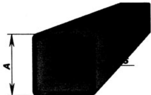
Таблица 8. Трубы из горячекатаной травленой резаной ленты
