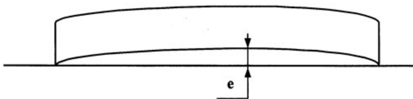
**Рис. 9 Отклонение от прямолинейности (кривизна)**
